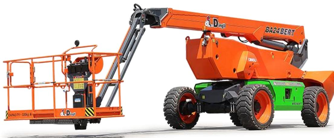
Модификация коленчатого подъемника со складным гуськом.
