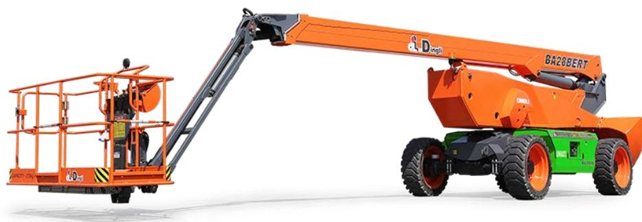
Модификация коленчатого подъемника со складным гуськом.
