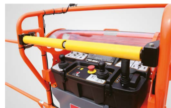
Устройство защиты от зажатия оператора
